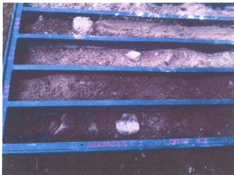
Fig. 5: Dettaglio carote estratte durante l'esecuzione del sondaggio
