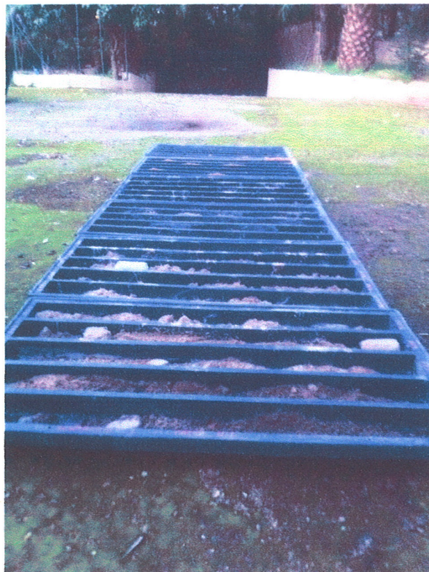
Fig. 9: Dettaglio carote estratte durante l'esecuzione del sondaggio
