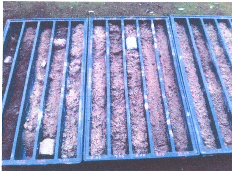
Fig. 7: Dettaglio carote estratte durante l'esecuzione del sondaggio
