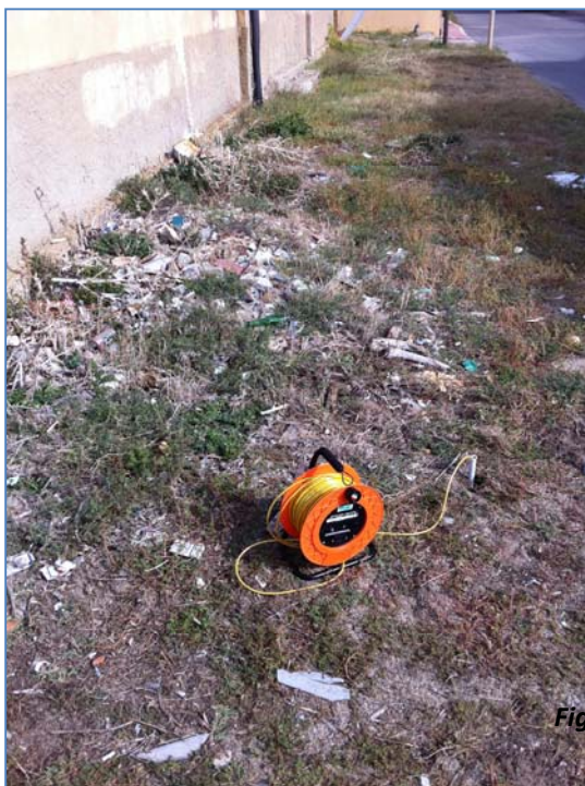
Fig.1 – misura piezometrica n°1
