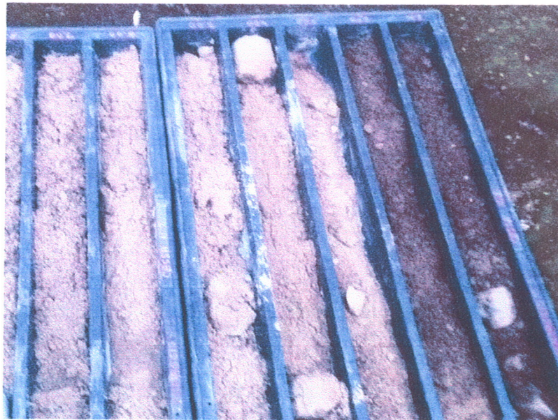
Fig. 6: Dettaglio carote estratte durante l'esecuzione del sondaggio
