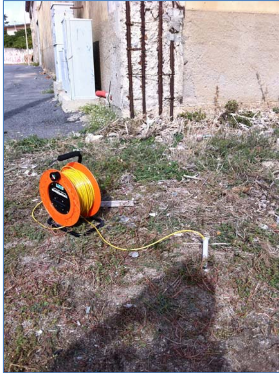
Fig.3 – misura piezometrica n°3
