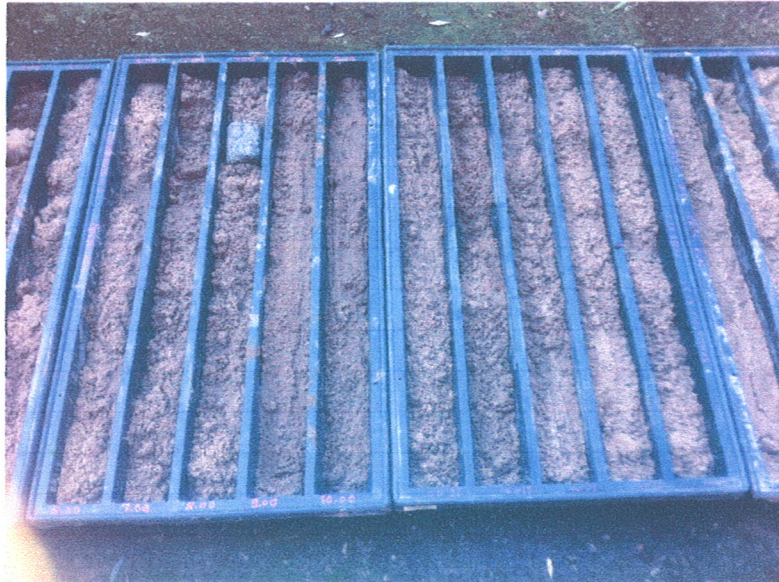
Fig. 8: Dettaglio carote estratte durante l'esecuzione del sondaggio
